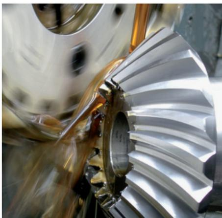
**Operazione di taglio di una corona conica spiroidale.**
