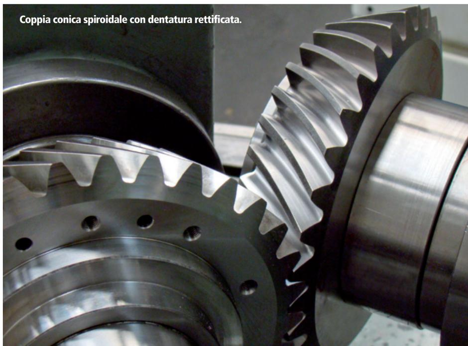
Coppia conica spiroidale con dentatura rettificata.
